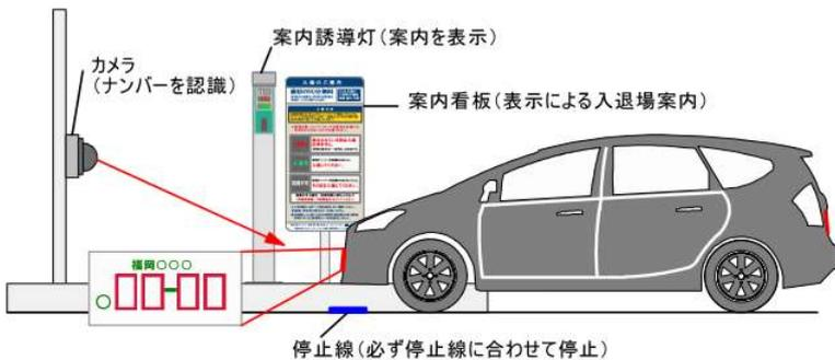
各出入口にて一旦停止をすると、カメラが作動し、車のナンバープレートを認識します。詳しくは案内誘導灯の表示により、指示に従ってください。
